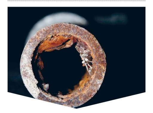
Die stürmische Entwicklung der Stahlindustrie im 19. Jahrhundert ermöglichte zunehmend die Verwendung von Stahlrohren zur Fortleitung von Wasser. Leider führt die Kor-
